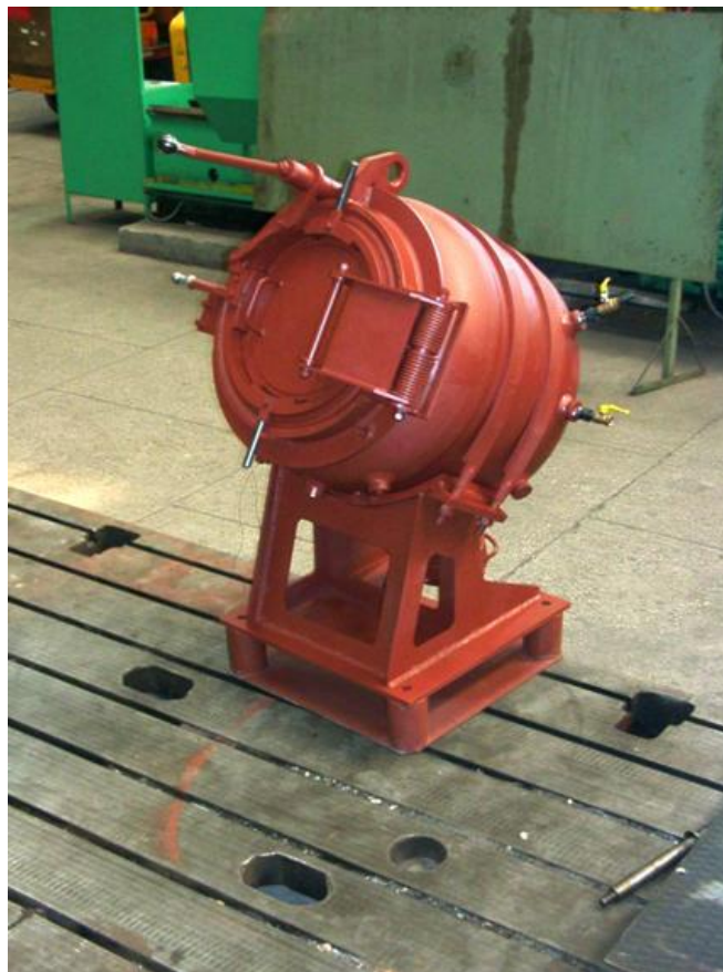
5. ábra: KIP-0.2 tip. robbantókamra; A kamra össztömege 0.85 t, méretei: 1030 x 850 x 1400 mm
