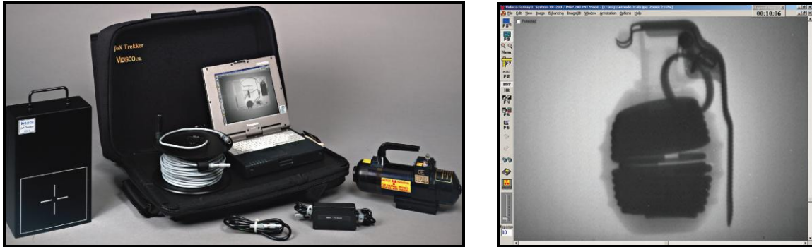
5-6. ábra: foX-Trekkal Vidisco hordozható röntgen rendszer és a kijelző munka közben 12
