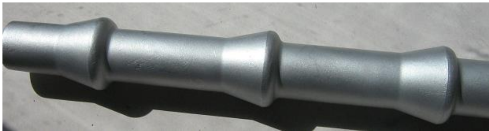
12. ábra: A cső a második tágitó robbantás után
